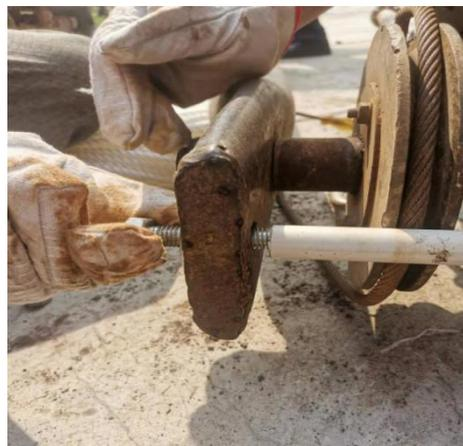
钻机塔架顶端触电痕迹
