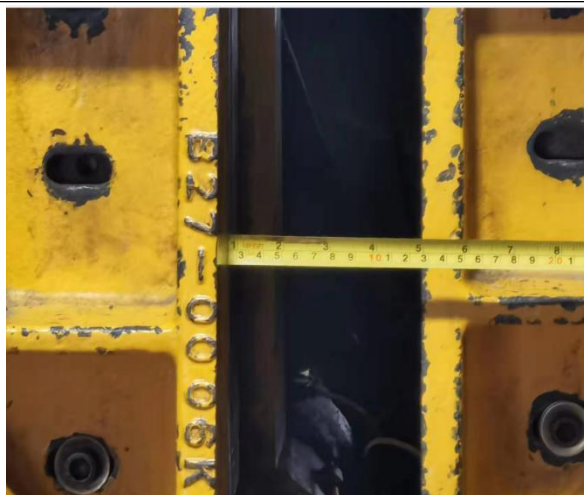
图 7 左右两模具内侧最小开口间距
