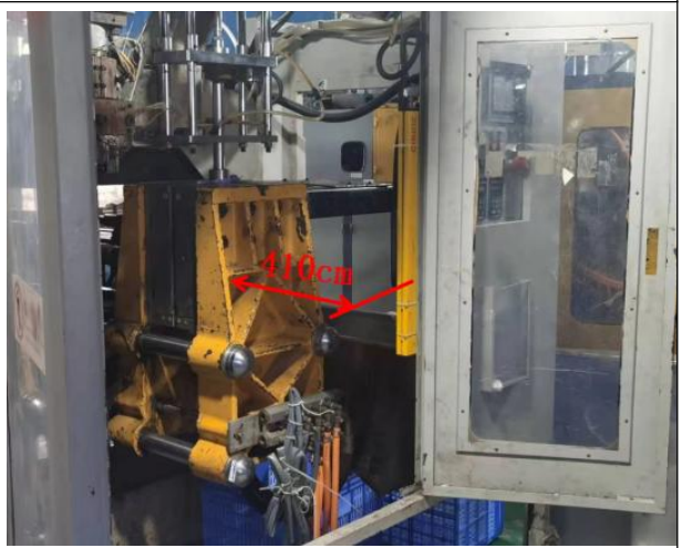
图 8 安全门与吹塑机模块的间距
