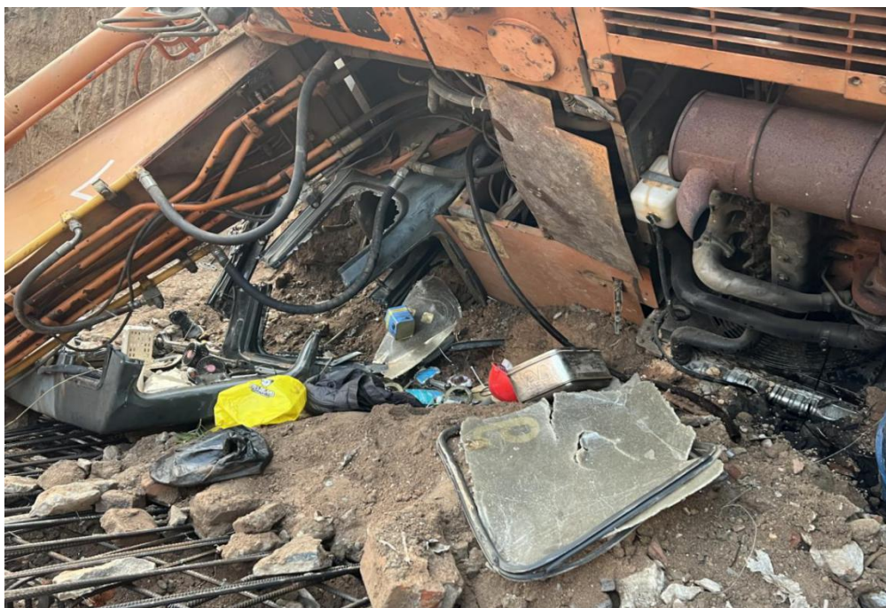
图 4 已破拆的涉事挖掘机驾驶室
