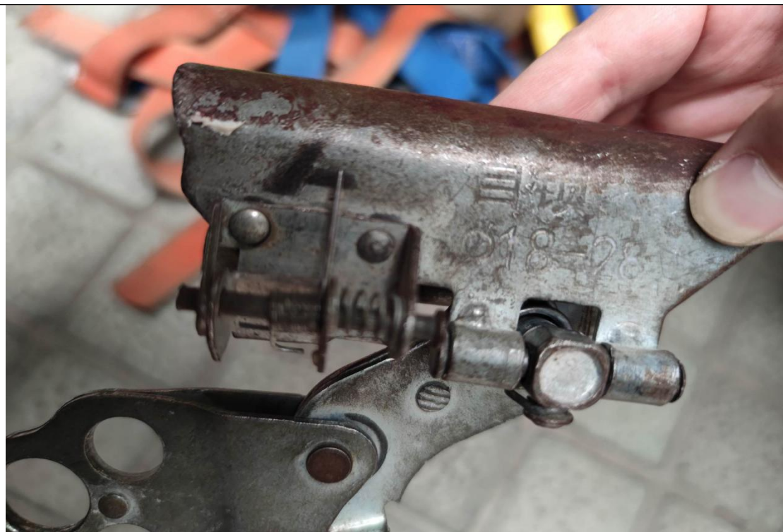
图6 涉事生命绳自锁器（型号Φ18-28）
