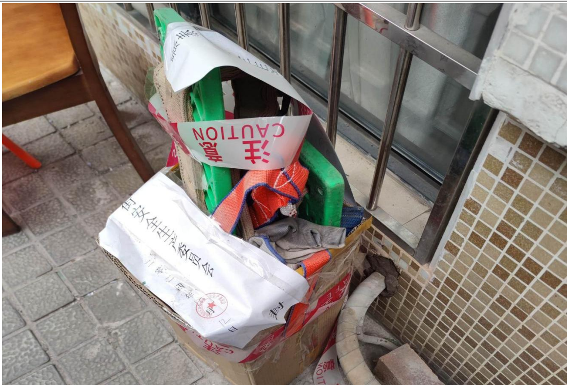
图 8 涉事现场的安全带和座板装置
