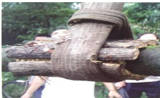
1、装车前在起吊位系结软绳
